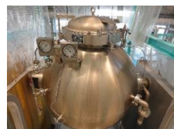
バイオマスを分解し易くするための水熱処理装置
