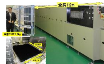
スーパーグロース法による単層CNT製造実証プラント
