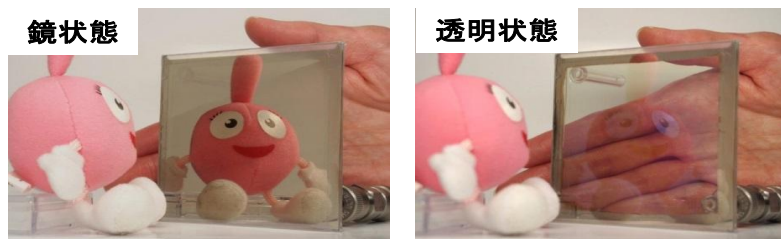
鏡状態の調光ミラーが鮮やかに透明状態に変化する。
