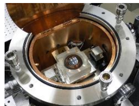
同位体濃縮シリコン結晶球 の直径をサブナノメートル の精度で測るレーザ干渉計
