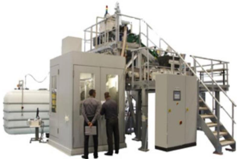
**SELF-RAG社の電気パルス粉砕機（LAB機と1 t/h連続試験機）**
