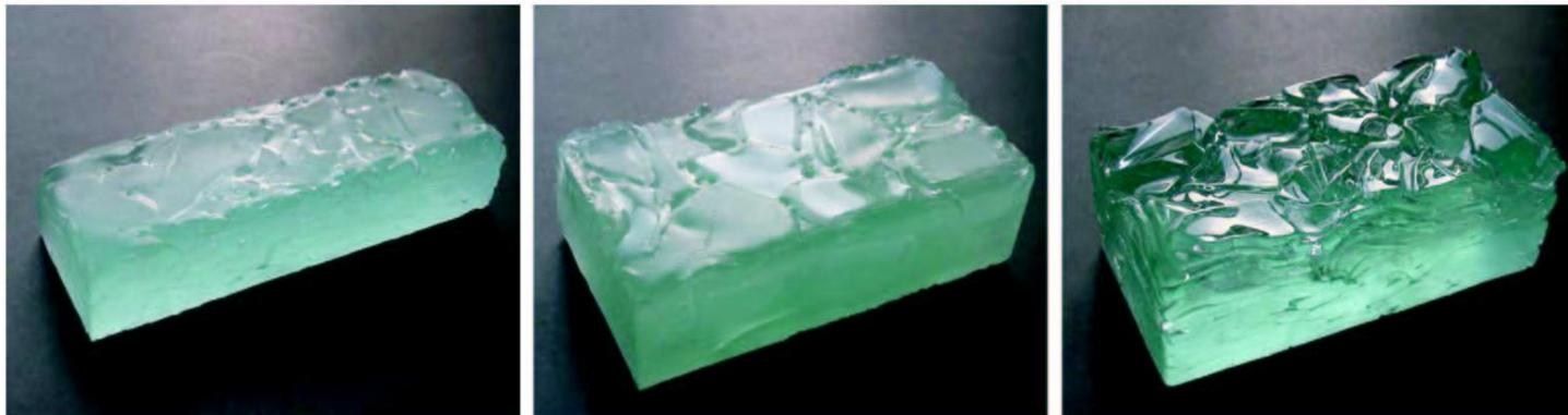
破碎された廃棄ガラス“ガラスカレット”の形状履歴を残した状態で溶着する
