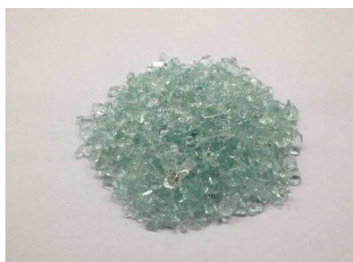
図2 破碎後の GMA カレット写真
