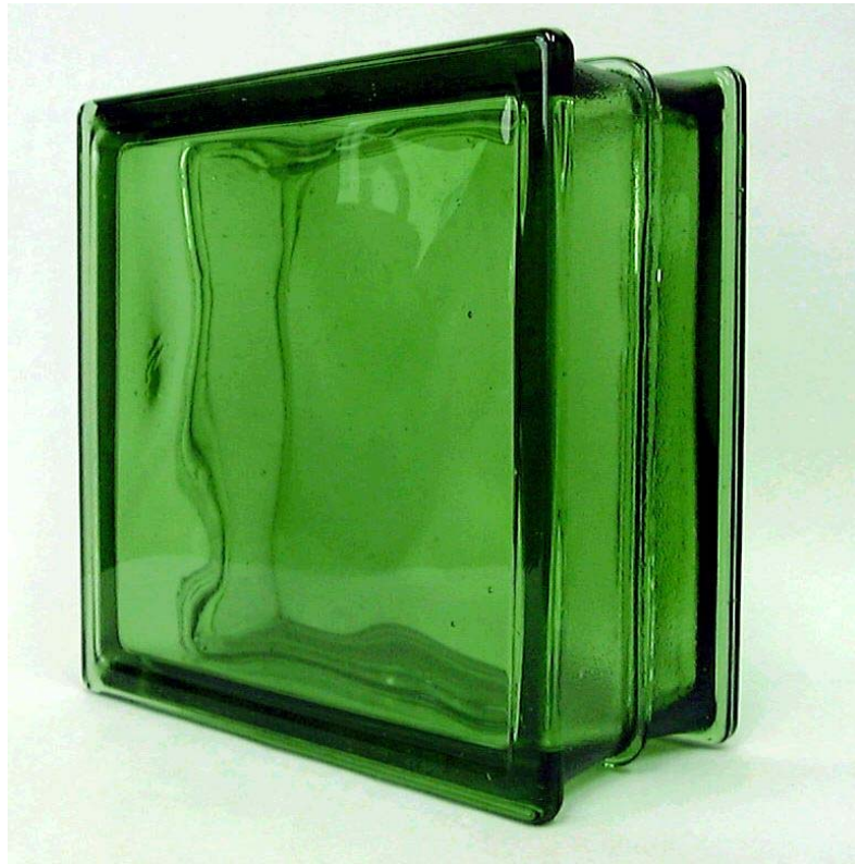
図 5-1 エコガラスブロック試作品（外観：濃いエメラルドグリーン）
