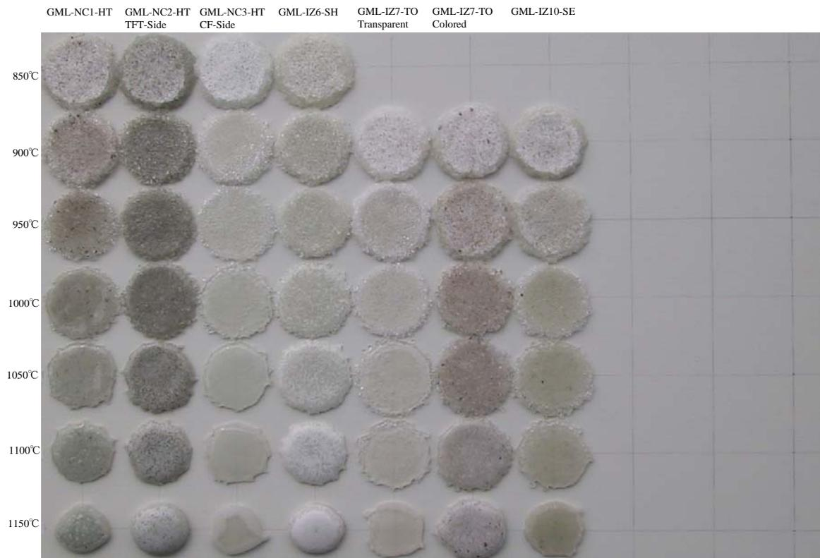
第 2. 2-4 図 各熔融温度における各種廃ガラスの熔融状態
