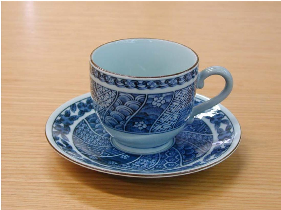
第 3.2-7 図 合成長石を 30%使用した試作品.
