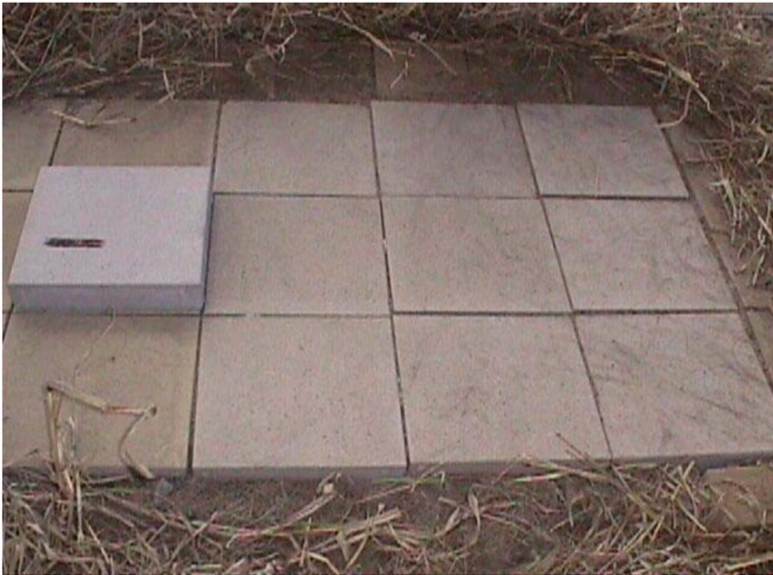
第 4.2-7 図 クリスタルファイン 10%添加試作品の曝露状況写真(3 ヶ月経過)
