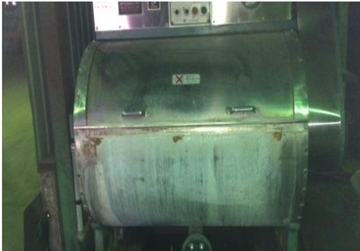
中間膜剝離バレル
