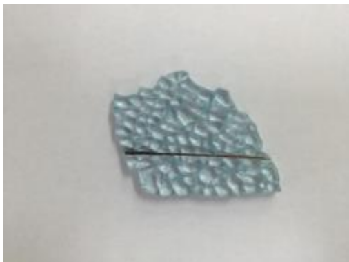
①剥離処理まえ(熱線有)
