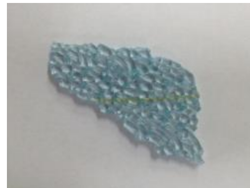
③剥離処理あと(熱線・糊剥離)
