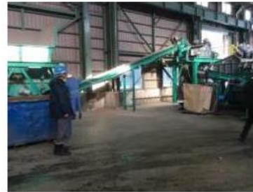
図 破碎後ホッパーへ投入
