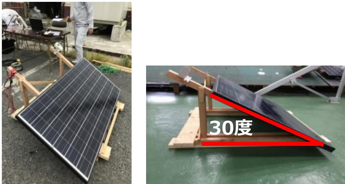
写真 4.2.2 I-V チェッカーを用いた PV モジュール検査用の検査台
