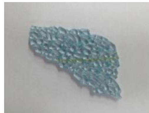
③剥離処理あと(熱線・糊剥離)
