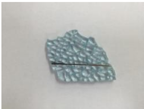
①剥離処理まえ(熱線有)
