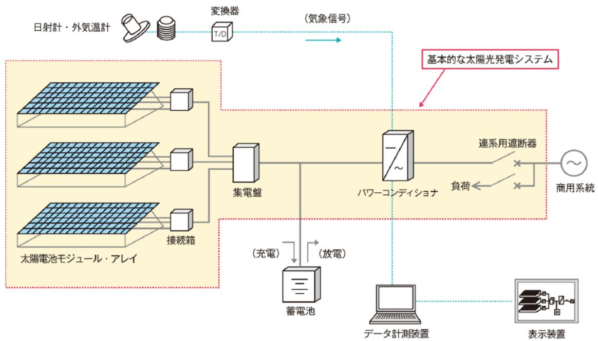
図表 4 太陽光発電システムの概要
