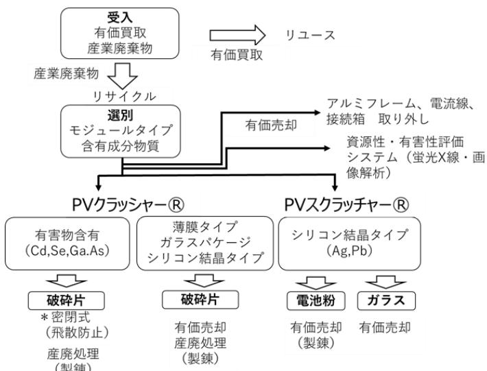
図表 35 PV クラッシャーR、PV スクラッチャーリサイクルによる処理フロー
