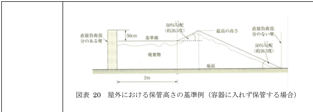
図表 20 屋外における保管高さの基準例（容器に入れず保管する場合）
