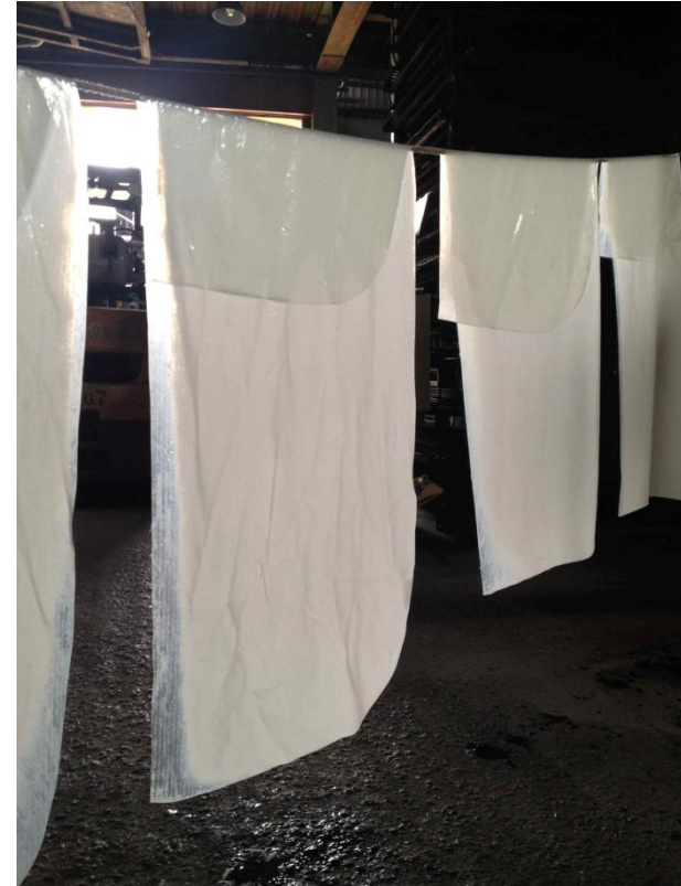
Drying of PVB film 中間膜の乾燥
