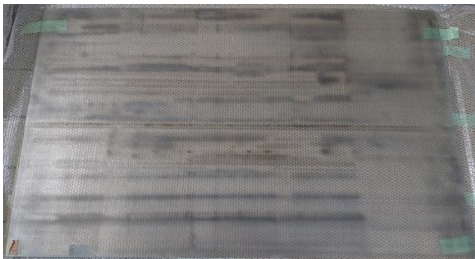
図 3.2-9 切削処理によるガラスプレート（本事業にて取り寄せたサンプル） 備考）黒い部分は切削分離機器であるローラー痕である。
