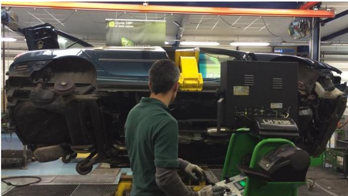
反転機 触媒回収とエンジン分離
