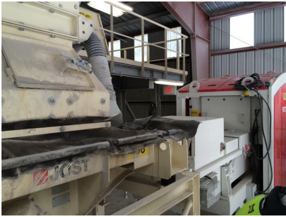
ガラスセンサー（ガラス選別）、カラーセンサー（透明ガラス選別）、X線センサー（鉛除去）
