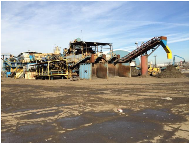
シュレッダーで鉄選別後の、非鉄プラ MIX は別ラインにて処理
