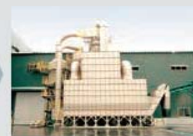
集塵装置 対象物を破碎した際に発生した粉塵を回収します。
