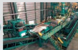
磁力選別ライン 磁力で鉄と非鉄金属・ダストに選別します。
