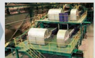
非鉄選別ライン ミックスメタル・ダストに選別します。
