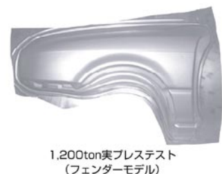
1,200 t actual press test(Fender model)
