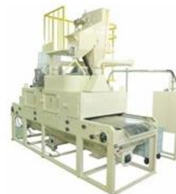
導入事例② ブラスト工法によるガラス剥離装置
