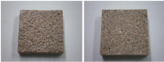
図 3：太陽光発電パネルから回収し前処理したガラスカレット（GMPV: Glass Material recovered from Photovoltaic）を使った磁器タイル（左）と透水性タイル（右）の外観
