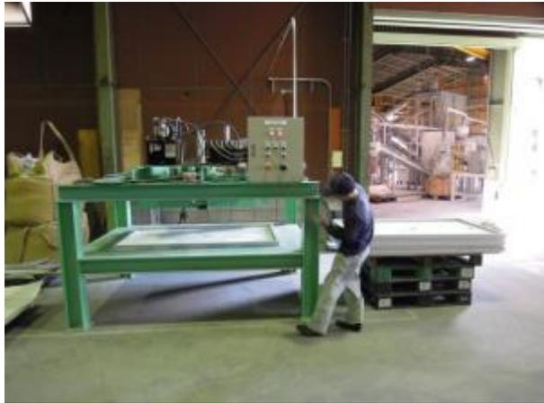
アルミフレーム枠外し機
