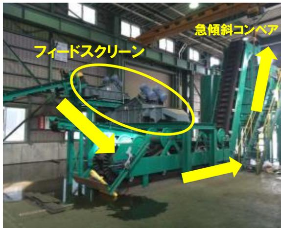
② 投入したパネル破碎屑は、原料供給コンベアで運ばれ2つのフィードスクリーンでふるいにかける。一定粒径内の破碎屑は急傾斜スケールコンベアを経て選別機本体へ運ばれる。
