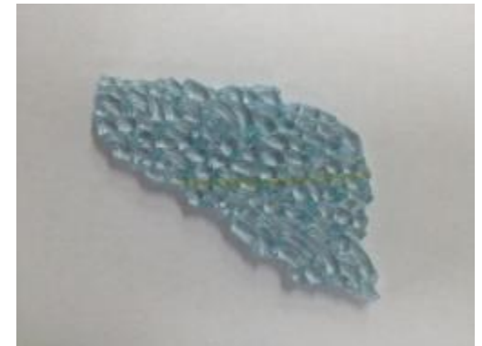
③剥離処理あと(熱線・糊剥離)
