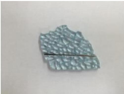
①剥離処理まえ(熱線有)
