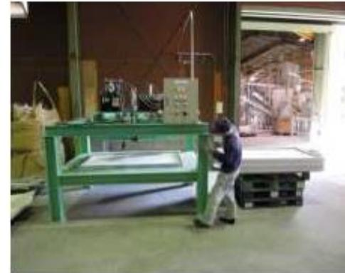
図 アルミフレーム枠外し機
