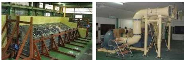
上左：水平型動風圧試験装置
