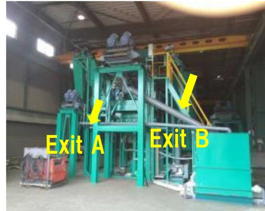
③ 選別機本体内で水の隆起・沈降を繰り返し、物質の比重差によって、2種類のマテリアルに分離。水切りを行った後、A・Bの出口よりそれぞれ回収される。
