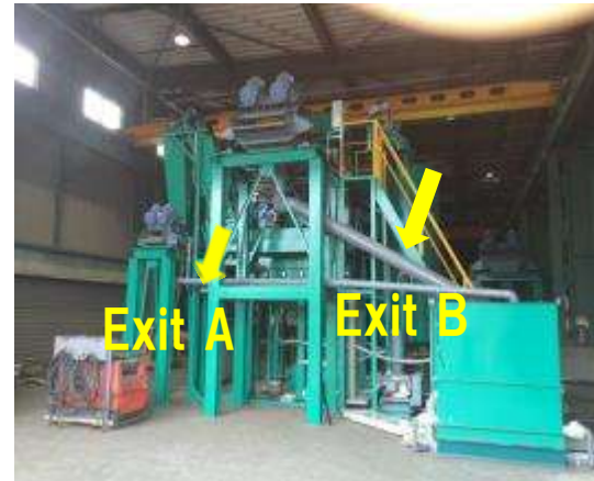
③ 選別機本体内で水の隆起・沈降を繰り返し、物質の比重差によって、2種類のマテリアルに分離。水切りを行った後、A・Bの出口よりそれぞれ回収される。
