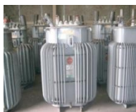
高圧トランス
