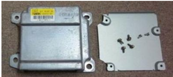
自動車解体によるエアバッグ・エンジンコンピューターの取り出し
