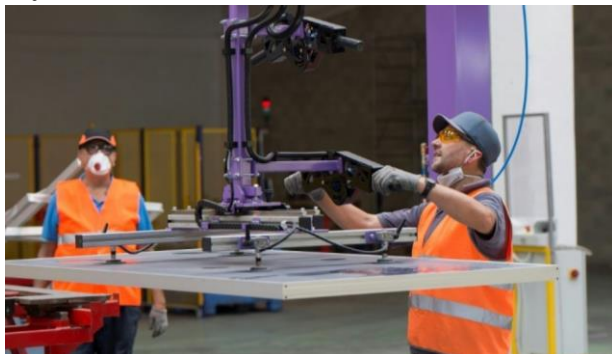
図 2 アルミフレーム・J-Box 除去
