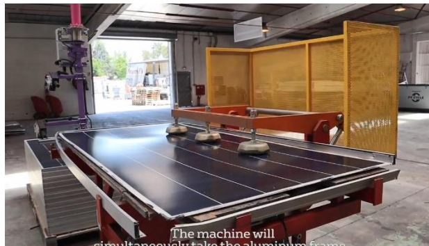
図 2 アルミフレーム・J-Box 除去
