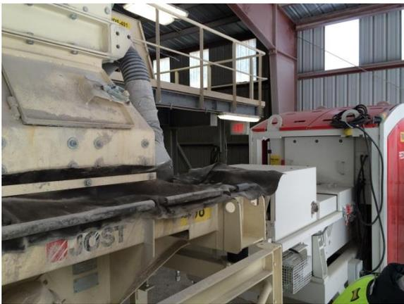
ガラスセンサー（ガラス選別）、カラーセンサー（透明ガラス選別）、X線センサー（鉛除去）
