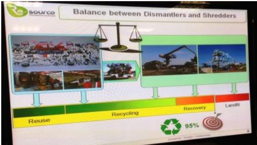
95%のリサイクル率を達成するには、解体とシュレッダーのバランスが必要になる。部品の再利用と資源リサイクルとエネルギーリカバリーを組み合わせ、低コストで最適なりサイクルを実現させる必要がある。
