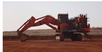
超大型油圧ショベル EX3600-7 (バックホウ仕様)
