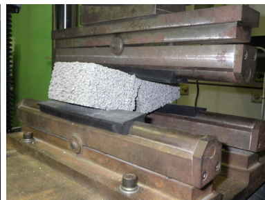
曲げ載荷状況
