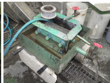
透水試験状況
