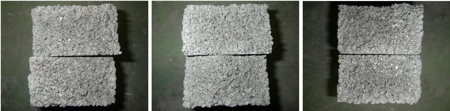
透水性I.L.B 破断面
