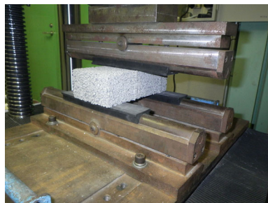
曲げ載荷状況
