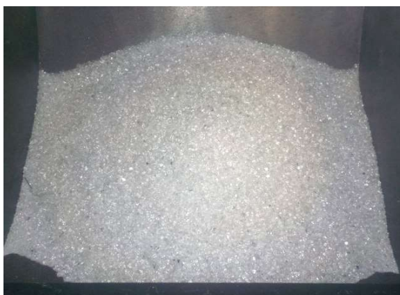
写真2. ロサンゼルス試験機内に投入したガラスカレット
