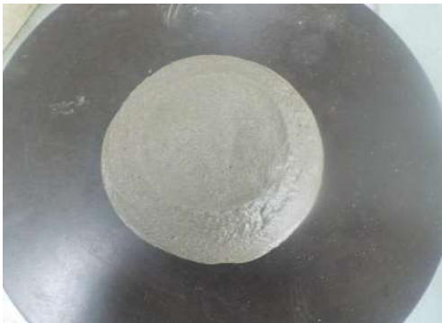
写真8. 基準モルタルのフロー
