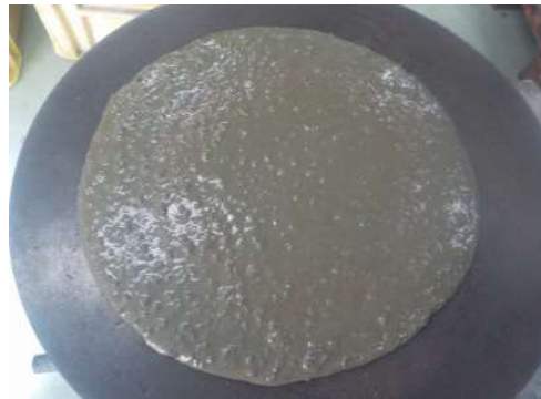
写真9. エッジレス処理無ガラス入りモルタルのフロー
