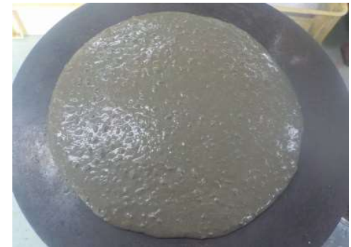
写真10. エッジレス処理有ガラス入りモルタルのフロー
