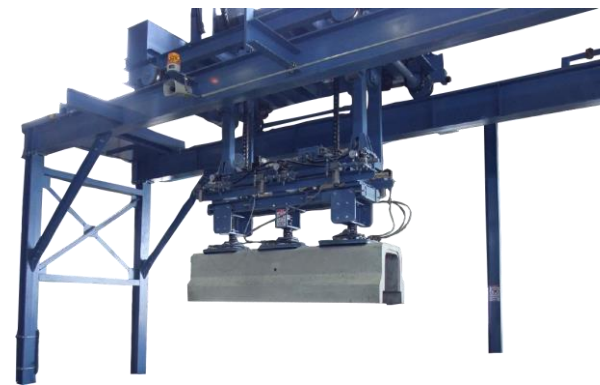
コンクリート製品脱型装置
