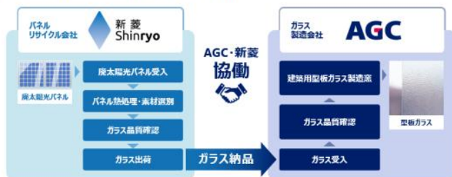
太陽光パネルカバーガラスのリサイクル工程
