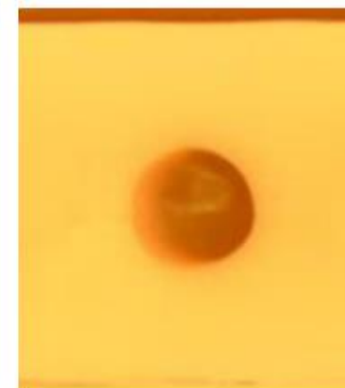
アンモニア 100% (アンモニア火炎は輝度が低いため見えづらい)
