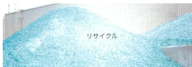
**GHG削減効果：**カレットはバージン原料よりも溶解しやすいため、燃料の削減に繋がる。また、バージン原料に炭酸塩を使用しており、溶解時にCO<sub>2</sub>が発生するが、カレットを増やすと、炭酸塩の使用量が減少するため、CO<sub>2</sub>の発生を抑えることができる。よって、1 Tonのカレットを、バージン原料の代わりに再利用することで、約0.5~0.7TonのCO<sub>2</sub>発生を抑制できる(Scope1+2+3)。
