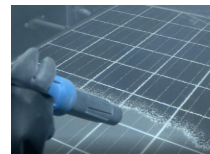
▲ 廃太陽光パネルリサイクル (ショットブラスト法)
