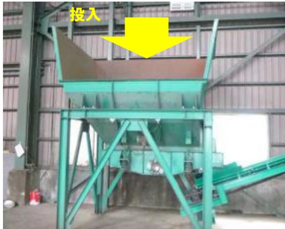
① シュレッダーで破碎した太陽光パネル層をホッパーへフォークリフトで投入。
