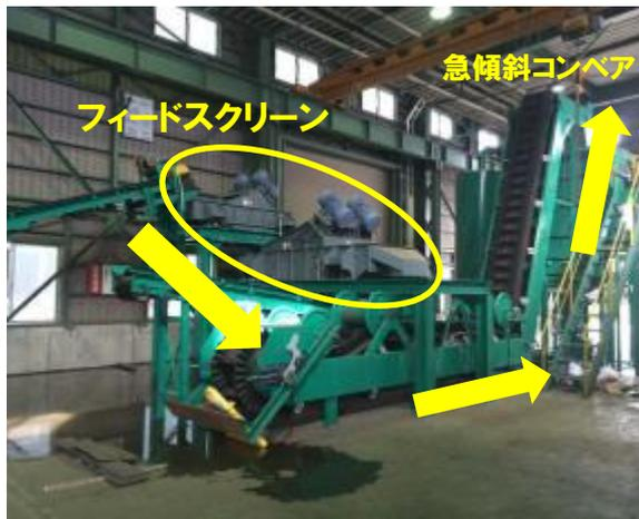
② 投入したパネル破碎層は、原料供給コンベアで運ばれ2つのフィードスクリーンでふるいにかける。一定粒径内の破碎層は急傾斜スケールコンベアを経て選別機本体へ運ばれる。
