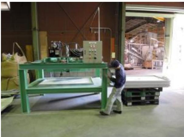
アルミフレーム枠外し機
